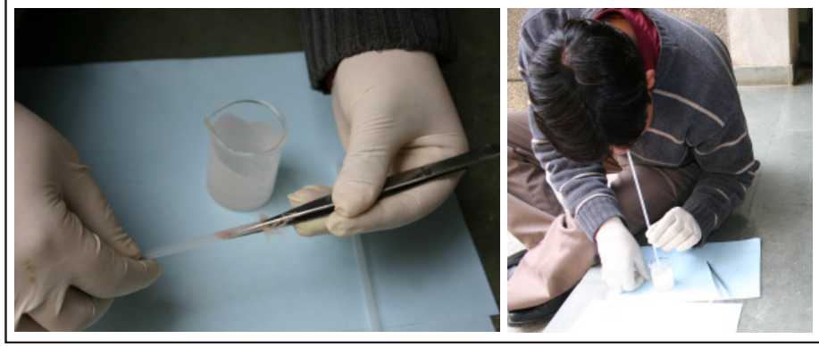
Şekil 26. Kılların enine kesitlerini hazırlama yöntemi
